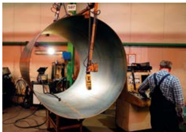
Poszczególne segmenty zbiornika, a następnie dennice są wstępnie łączone.
