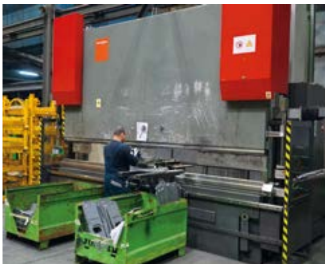
Z odpowiednio wyciętych arkuszy blach za pomocą pras krawędziowych wygina się odpowiednio ukształtowane profile.
