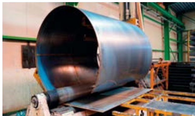
Na innych maszynach, zwanych walcarkami, z płaskiej blachy są zwijane sekcje zbiorników.
