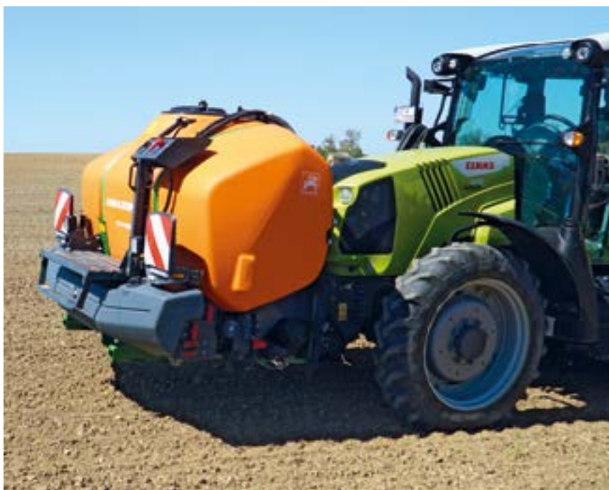
Przedni zbiornik Amazone FT-P 1502 mieści 1500 l cieczy roboczej i 180 l czystej wody.
