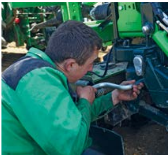
Głębokość sadzenia bulw reguluje się za pomocą korby.
