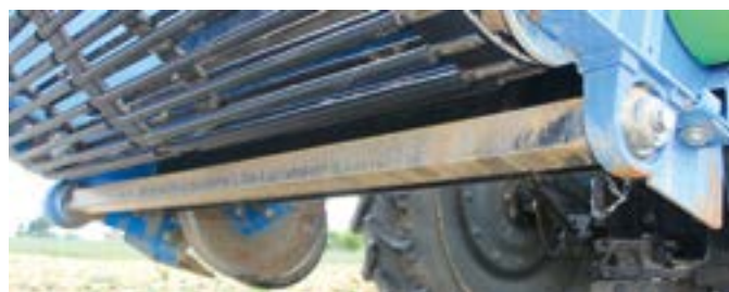
Sercem zespołu kopiącego jest napędzana belka o przekroju kwadratu z bokiem o długości 5 cm.
