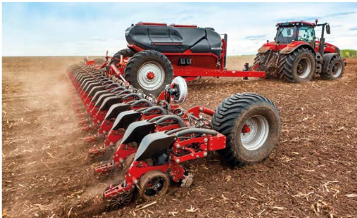
Na rynku dostępnych jest kilka systemów pozwalających na automatyczną regulację nacisku redlic.
