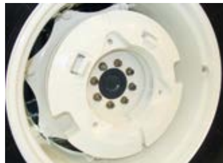
Obciążniki tylnych kół ważą po 82 kg. Maksymalnie możemy zamontować po dwa pierścienie do jednej tarczy.
