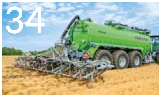
Aplikator doglebowy XXL z ciekawym mechanizmem składania
