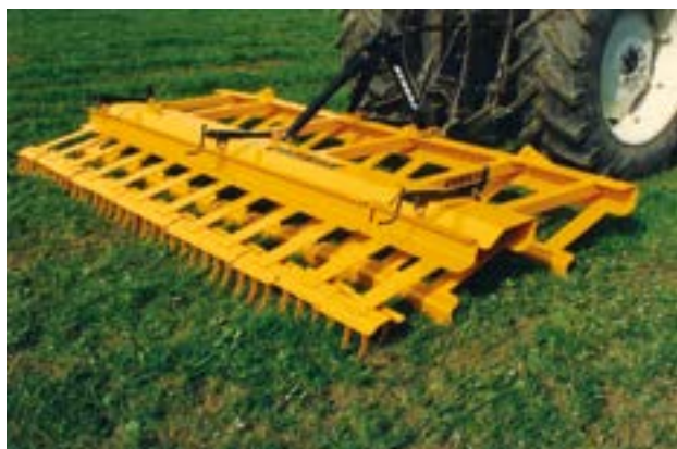
Pierwsze brony łąkowe Joskin nosiły nazwę EB i wyposażone były w zęby sztywne do rozgarniania odchodów zwierzęcych i kretowisk.
