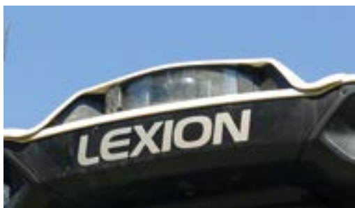
Czujnik Field Scannera wrócił na zewnętrzną część dachu i zyskał wycieraczkę.
