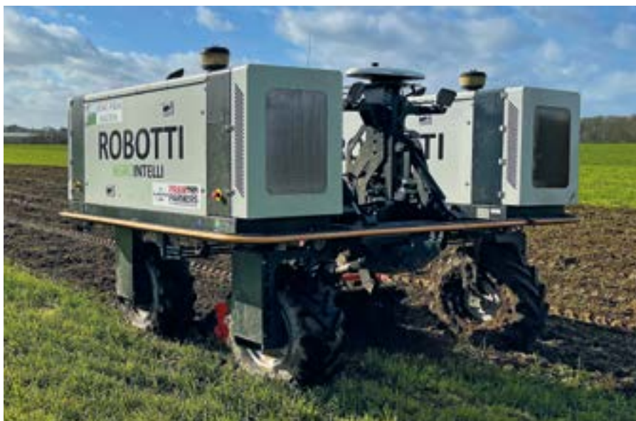
Autonomiczna uprawa aktywna gleby wykonywana przez robota Robotti 150D o mocy 150 KM zagregowany z glebogryzarką.
