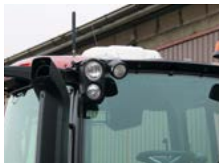
Odbiornik sygnału nawigacji satelitarnej i antena do jego korekcji świadczą o dostępności w tym ciągniku kierowania automatycznego z dokładnością +/- 2 cm.
