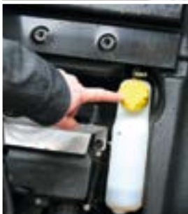
– Po odkręceniu dwóch śrub schodki można odchylić, co pozwala uzyskać dostęp do zbiorniczka wykorzystywanego jako wziernik stanu oleju hydraulicznego. W przypadku na przykład pęknięcia węża hydraulicznego właśnie w tym miejscu należy olej uzupełnić – wyjaśnia Łukasz Masiakowski.
