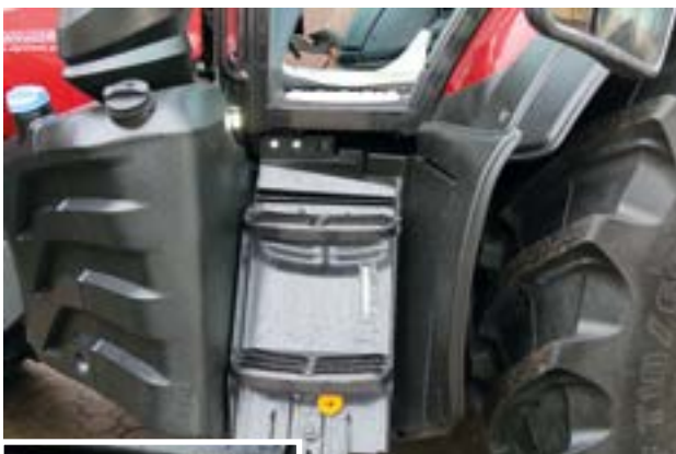
– Po odkręceniu dwóch śrub schodki można odchylić, co pozwala uzyskać dostęp do zbiorniczka wykorzystywanego jako wziernik stanu oleju hydraulicznego. W przypadku na przykład pęknięcia węża hydraulicznego właśnie w tym miejscu należy olej uzupełnić – wyjaśnia Łukasz Masiakowski.
