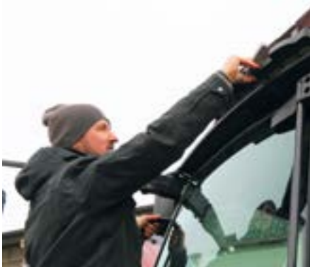
Demontaż i montaż filtra klimatyzacji znajdującego się w dachu kabiny po jej lewej stronie odbywa się jedną ręką. W tym czasie stojąc na schodkach kabiny trzymamy się drugą ręką uchwytu.
