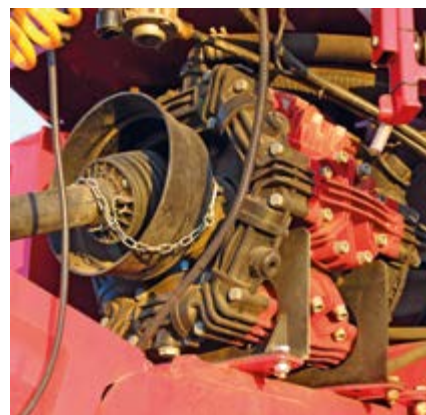
Pompa membrano-tłokowa Zeta 400 ma wydajność 400 l/min.
