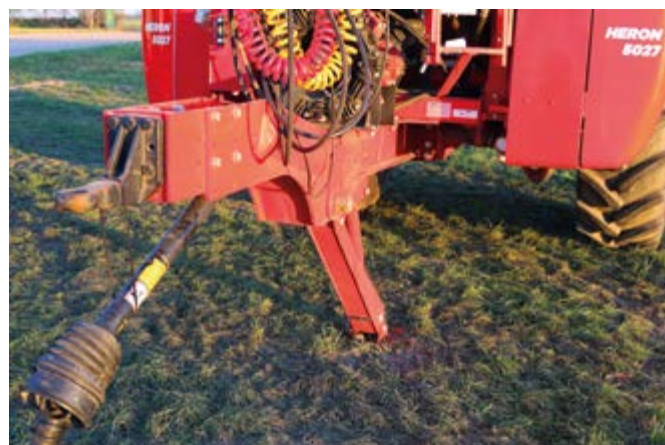
Dyszel Herona można obracać, co pozwala agregować maszynę z ciągnikiem poprzez jego zaczep górny lub dolny.
