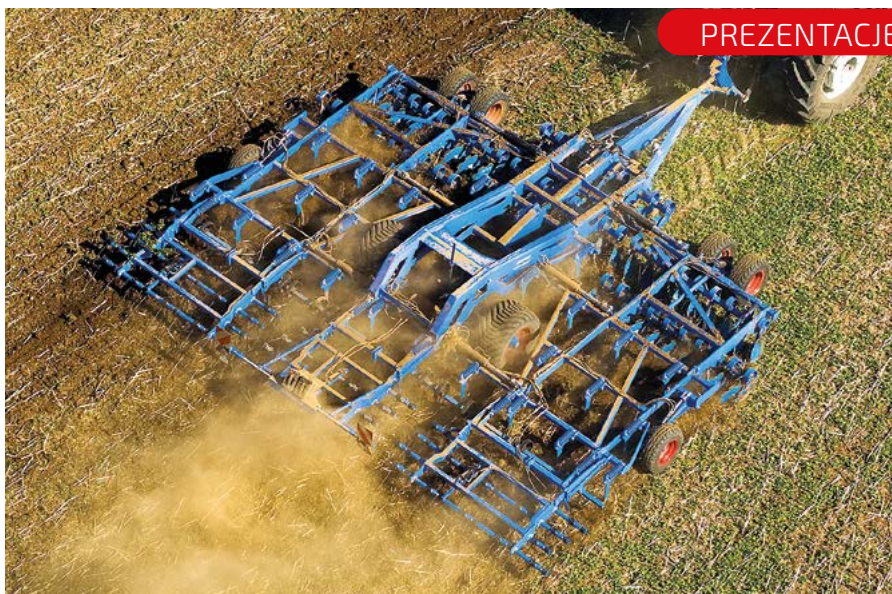
Za regulację i aktywne utrzymywanie głębokości roboczej zębów odpowiadają podwójne przednie i umieszczone w strefie kultywatora pojedyncze kota podporowe.
