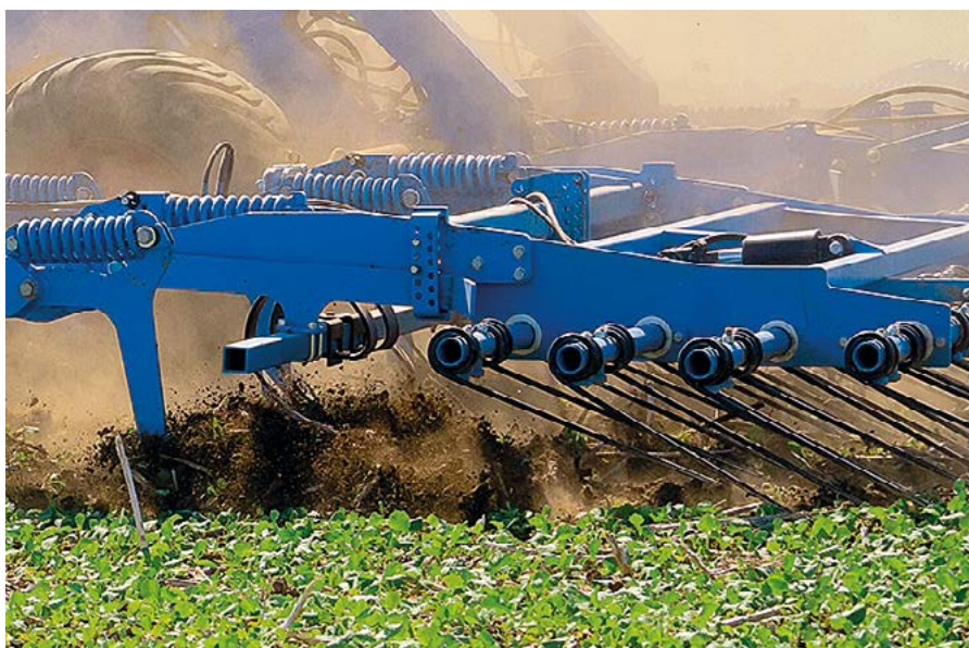
Jednym z wariantów segmentu zamykającego cykl roboczy jest czterorzędowe zgrzebło z nastawnym zdalnie kątem natarcia palców.
