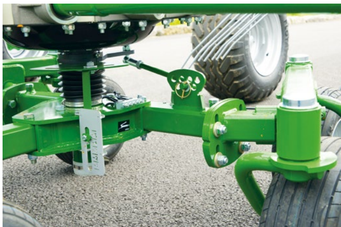
Maszyny mają mechaniczną regulację wysokości roboczej oraz kąta natarcia palców. W przypadku R68-78, znajdziemy w niej scentralizowane kalamitki pod obiema karuzelami.
