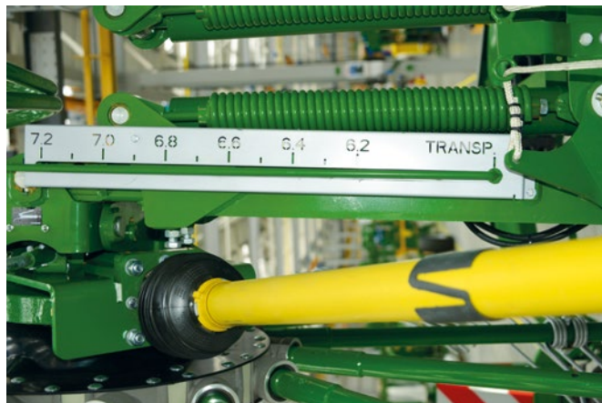
Zgrabiarki McHale mają hydrauliczną regulację rozstawu karuzel. Dzięki czytelnej skali ze wskaźnikiem operator może sprawdzić szerokość roboczą bez wychodzenia z kabiny.
