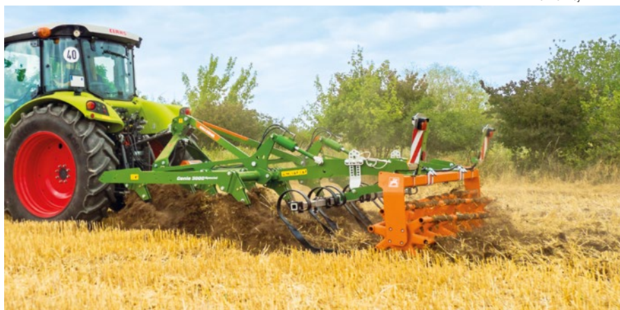
Cenio to mały kultywator 3-belkowy, wzorowany na Ceniusie. Ma 10 elementów roboczych, które mogą pracować do głębokości 25 cm.
