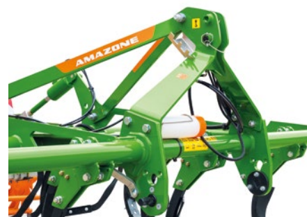
Cenio ma regulację umożliwiającą dostosowanie go do pracy z ciągnikami, wyposażonymi w różne kategorie TUZ-u.
