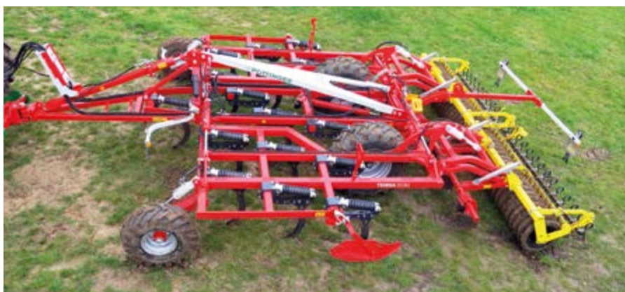
Łapy nowej gamy kultywatorów Terraia są ułożone w układzie V.
