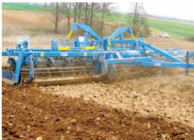
Włóka jest ważnym elementem agregatu uprawowego, gdyż niwelując nierówności przed pozostałymi narzędziami roboczymi, poprawia równomierność uprawy.
