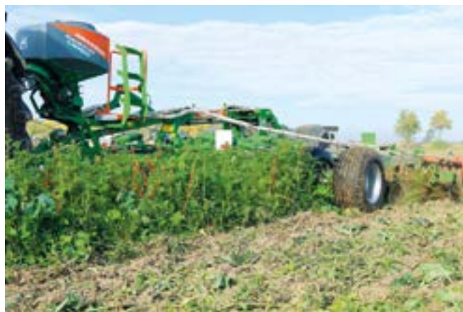
Pokaz pracy narzędzi Amazone odbył się na polu porośniętym poplonem mieszanki N-Fixx. Wcześniej została ona wysiana za pomocą widocznego siewnika poplonów GreenDrill zamocowanego na bronie Amazone Catros+ 8003-2TX.
