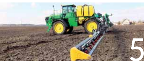
Opryskiwacz z karbonową belką
