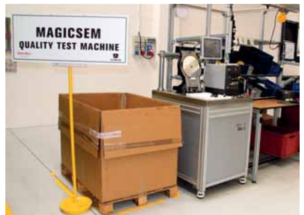
Stanowisko z aparaturą do testowania stabilności podciśnienia w komorze aparatu pojedynkującego siewnika punktowego. ➔
