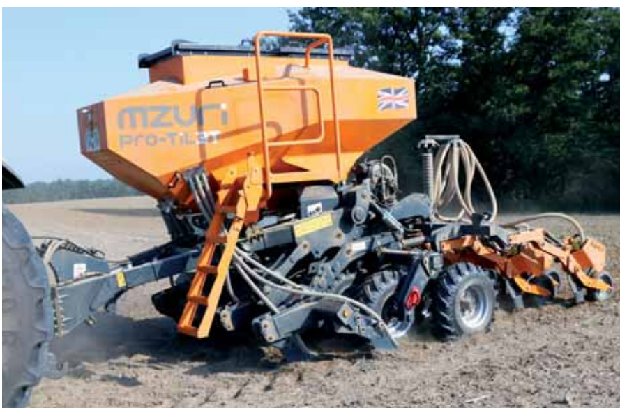
Agregat Mzuri Pro-Til 3T z redlicami do siewu punktowego Xzact może pracować z prędkością ok. 8 km/h.
