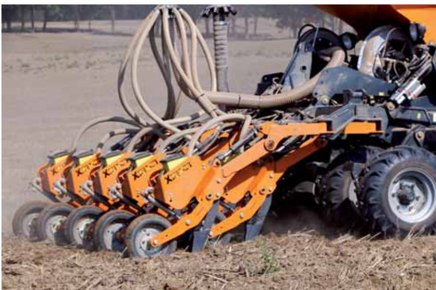
Aparaty pojedynkujące są montowane na standardowym ramieniu typowej redlicy siewnej Mzuri – wymienia się jej ostatni element (ten z kółkiem kopiującym), na którym właśnie mocuje się aparat dozujący pojedyncze nasiona.
