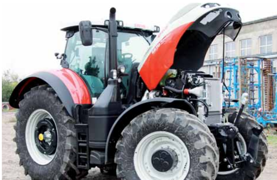
Pod maską ciągnika Steyr Terrus 6270 CVT zamontowany jest sześciocyldrowy silnik FPT o pojemności 6,7 l.
