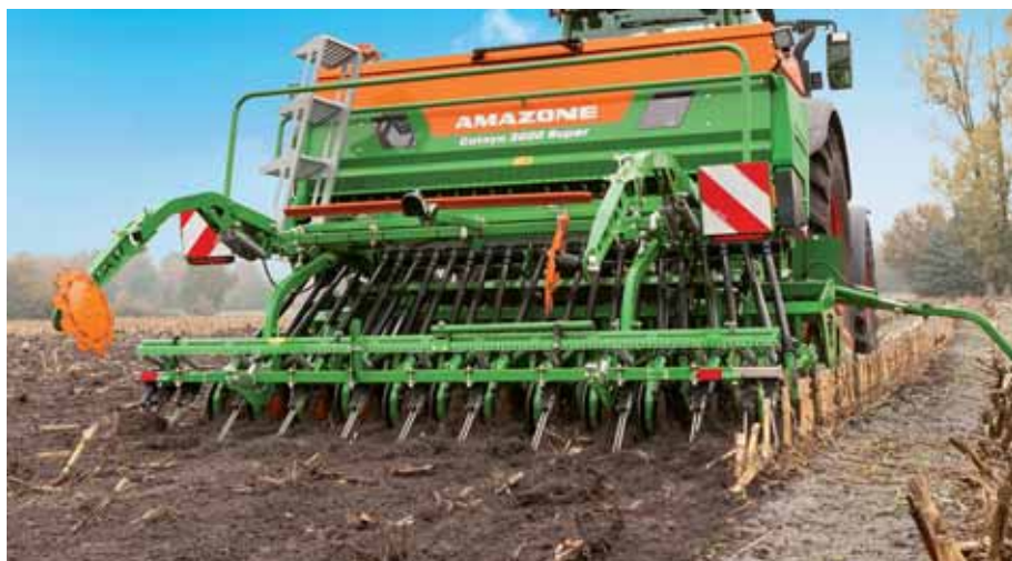
Nowy, aktywny trzymetrowy agregat uprawowo-siewny Amazone Cataya 3000 Super ma elektrycznie napędzany walek wysiewający. Na zdjęciu wersja maszyny z redlicami RoTeC.
