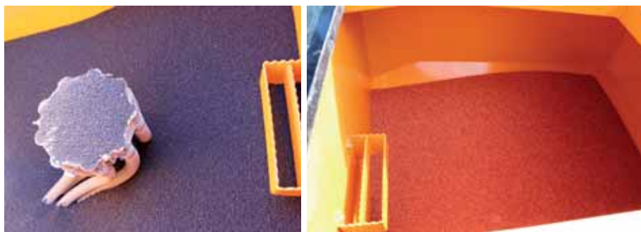
Przyczepiane agregaty do uprawy pasowej i siewu marki Mzuri mają dzielone zbiorniki, w proporcjach 40/60. W mniejszej części znajduje się nawóz, większa jest przeznaczona na materiał siewny.
