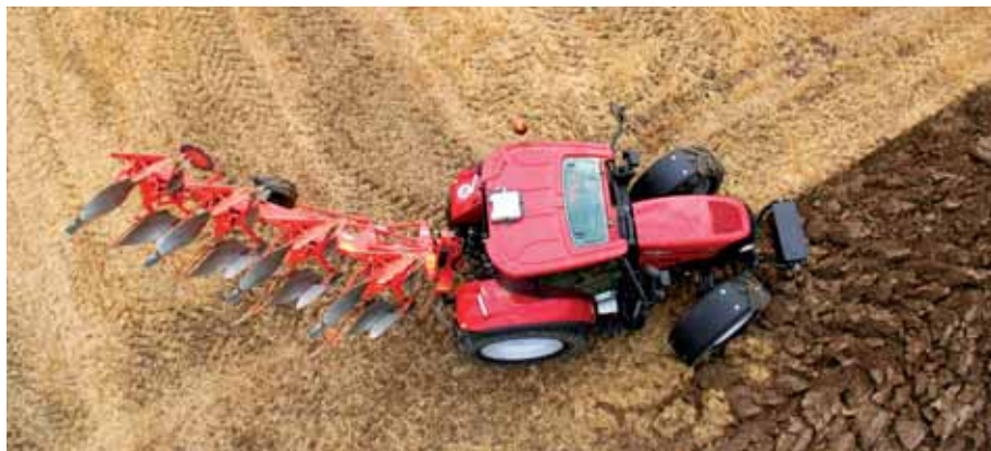
Case IH Luxxum 120 to ciągnik o zwartej konstrukcji i małym promieniu skrętu.
