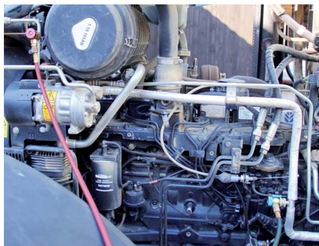
Do zaworów układu klimatyzacji podłącza się przewody specjalistycznego urządzenia serwisowego.
