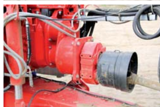
Pompa umieszczona jest na ramie. Dlatego amortyzowany hydraulicznie dyszel może swobodnie się pod nią poruszać.
