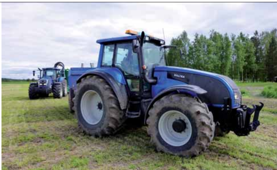
Ogumienie A365 Agristar należy do rodziny radialnych opon rolniczych o niskim profilu. Jak zapewnia producent, wzór bieżnika gwarantuje dobre samooczyszczanie.
