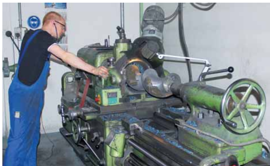
Dumą fabryki w Lohne są specjalne tokarki służące do wytwarzania rotorów pomp śrubowych. Maszyny te zostały zaprojektowane przez samego założyciela, Otto Meyera.
