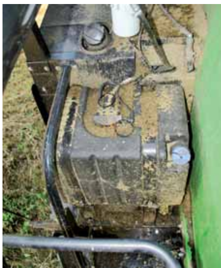
Dostęp do tankowania zbiorników paliwa i płynu AdBlue znajduje się z lewej strony. Ten pierwszy ma pojemność 750, zaś drugi 85 l.
