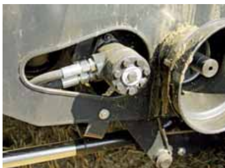
W maszynie C9205 TS zastosowano hydro- statyczny napęd wsteczny przenośnika po- chyłego i hedera.
