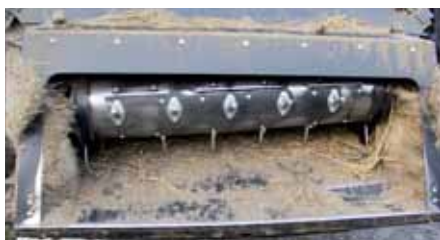
W przedniej części gardzieli nowego kombajnu znajduje się wyrównujący strumień ma- sy żniwnej podajnik z wysuwanymi palcami.
