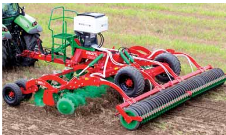
Mars Twix z opcjonalnymi: przednimi kołami podporowymi i siewnikiem poplonów ETA.
