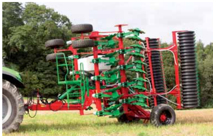
Mars złożony siłownikami hydraulicznymi do transportu nie przekracza szerokości 3 m.
