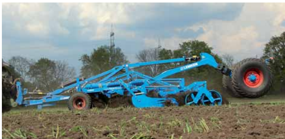
Nowy, lżejszy Karat jest oferowany z wózkiem transportowym. Pozwala to na podczepianie narzędzia do ciągników z hydrauliką o mniejszej wydajności.
