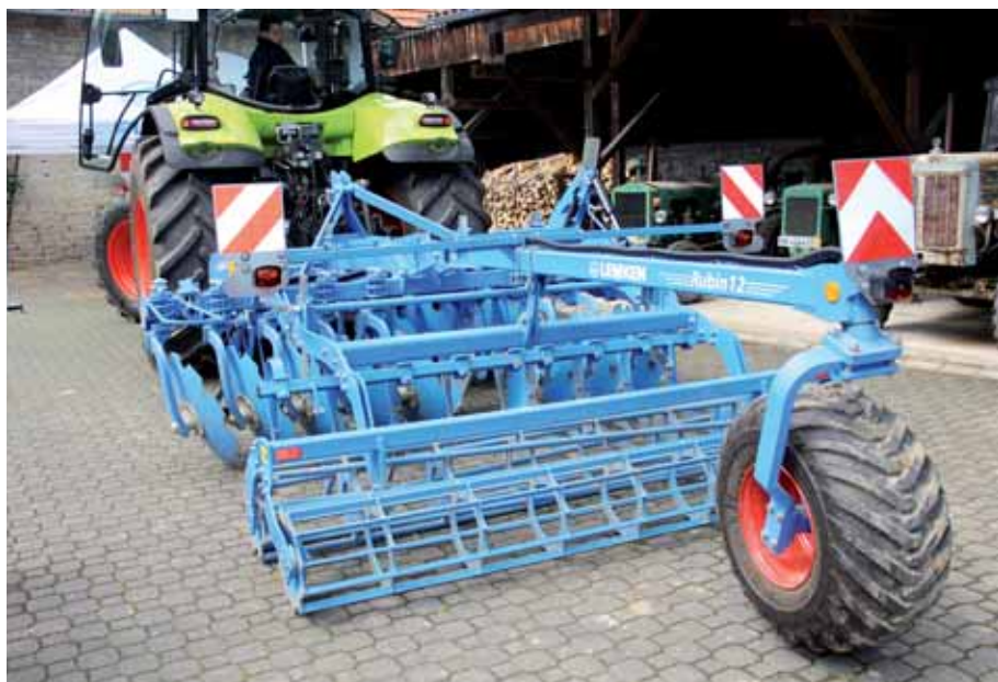
Zastosowanie jednego koła podporowego na ramieniu sterowanym hydraulicznie umożliwia pracę Rubina 12 z ciężkimi wałami, bez odciążania przednich kół ciągnika, powodującego utratę sterowności.
