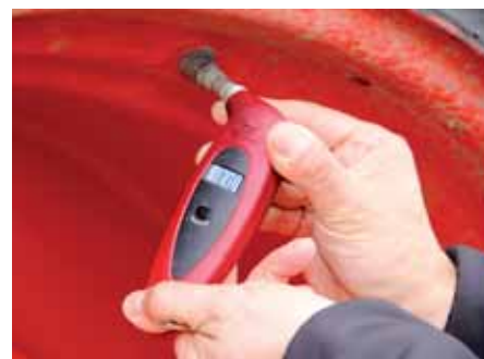
Pomiar ciśnienia w każdym kole ciągnika powinniśmy traktować jako czynność, którą w czasie prac polowych wykonujemy codziennie.
