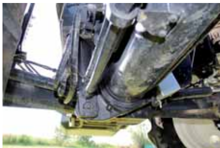
Amortyzacja przedniej osi z jednym siłownikiem to specjalność koncernu CNH. Na polu i na drodze jest naszym zdaniem nieodzowna.
