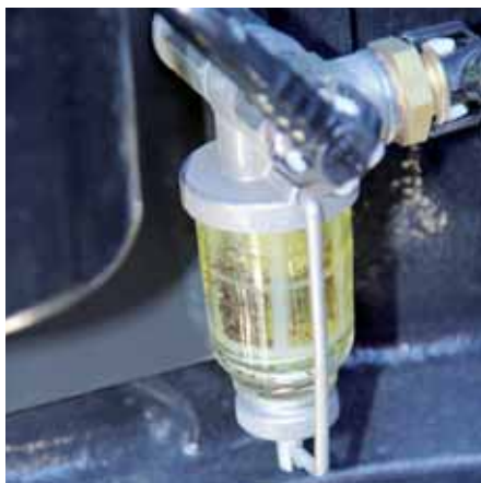
Prosty odstojnik, a jakże przydatny do sprawdzenia, ile zanieczyszczeń mamy w paliwie.
