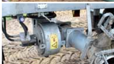
Tomasz Głębocki zaciąga płynny nawóz poprzez akcelerator przepływu, co podnosi wydajność napełniania w maszynie z kompresorem i redukuje wytwarzanie piany.
