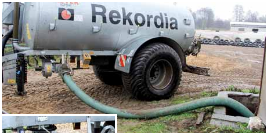
Tomasz Głębocki zaciąga płynny nawóz poprzez akcelerator przepływu, co podnosi wydajność napełniania w maszynie z kompresorem i redukuje wytwarzanie piany.
