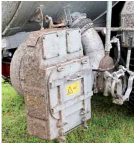
MeyloCut pozwala podczas napełniania oddzielić kamienie, a także pociąć włókniste frakcje zaciąganej gnojowicy.
