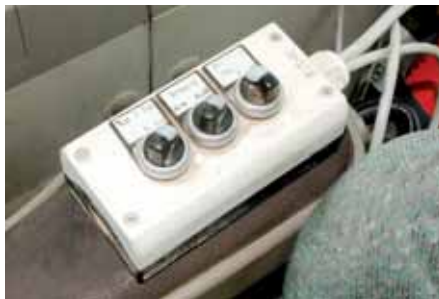
Do sterowania umieszczonym na dyszlu blokiem elektrozaworów służy panel obsługowy z wybierakami funkcji w formie pokręteł.
