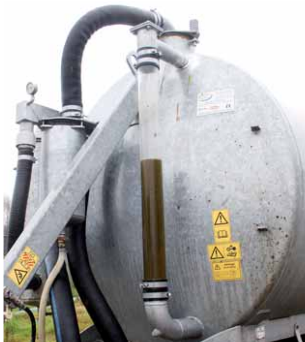
W wozie asenizacyjnym Leszka Jemielitego za kontrolę napełniania odpowiada zarówno wskazówka, jak i dodatkowo szklany wziernik w górnej części przedniej dennicy. W maszynie Tomasza Głębockiego odczyt poziomu gnojowicy w zbiorniku umożliwia przezroczysta rurka.
