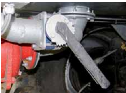
Do regulacji dawki nawozu służy zawór upustowy. Jego położenie ustawiamy dźwignią na żąbkowanym wycinku koła. Dostęp do niego znajdziemy z lewej strony w pobliżu króćca dolotowego.
