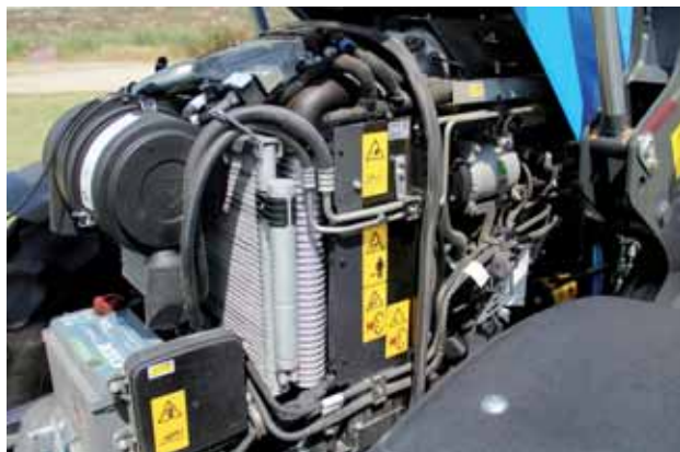
Pod maską ciągnika Landini 5-110H pracuje czterocylindrowy Perkins o pojemności 3,4 l i mocy nominalnej 105 KM.
