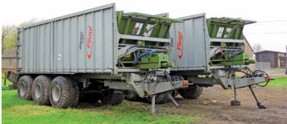
W gospodarstwie firmy Lech-Pol w Grocholinie od 2008 r. podstawą transportu są przyczepy Fliegl Gigant ASW 270 z wymiennymi adapterami. Służą jako roztrząsacze obornika, wozy przeładownicze oraz przyczepy objętościowe.
