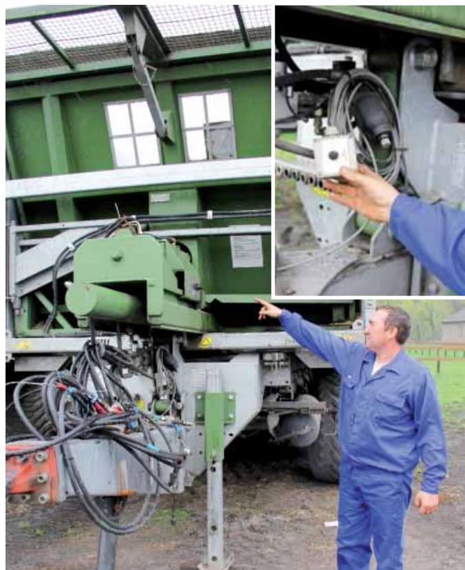
System przesuwaney przedniej ściany pozwala na dociśnięcie masy objętościowej, tak aby jak najwięcej jej zabrać w jednym kursie, oraz na wypychanie masy ze skrzyni bez jej podnoszenia. Do przesuwania służy tylko mały przełącznik, który możemy umieścić w kabinie.
