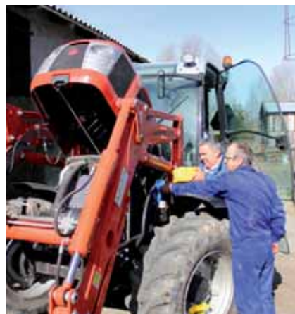
Okładka: Wymiana oleju silnikowego w Ursusie 10014 H Zdjęcie: Płocki
