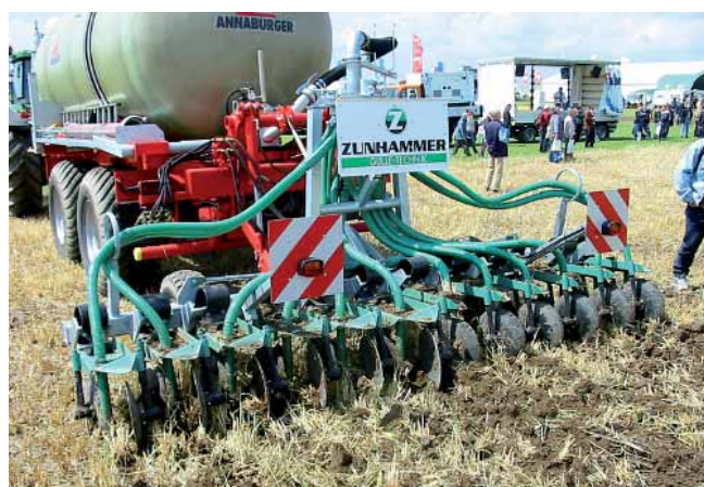
Zunhammer do nawożenia płynnymi nawozami odzwierzcącymi ma agregat talarzowy ZuniDrill. Talerze pierwszego rzędu w takich konstrukcjach są zawsze karbowane.
