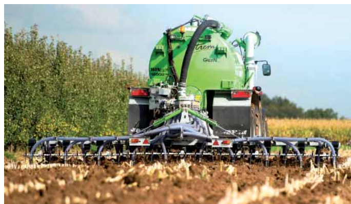
Terraflex/2 Joskina to jeden ze sposobów wprowadzania gnojowicy pod powierzchnię gleby. Agregat ma dwa rzędy sprężystych zębów.
