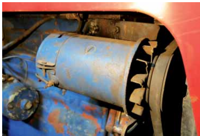
Prądnica P20d ma prostą konstrukcję. Można we własnym zakresie dokonać wymiany jej podstawowych elementów.
