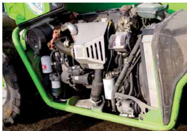
Po prawej stronie ramienia umieszczony jest czterocylindrowy doładowany silnik angielskiej marki Perkins o mocy znamionowej 101 KM.
