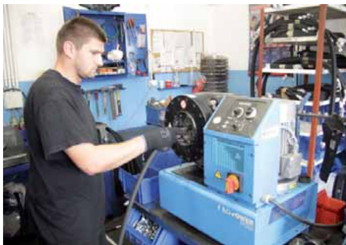
Prasa do zakuwania węży hydraulicznych pozwala zamontować na nich różnego rodzaju końcówki.
