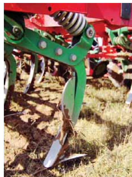
W czasie zrywania ścierniska na dwie grządziele skrajnych zębów przykręca się boczne nakładki, których zadaniem jest kierowanie strumienia gleby do środka agregatu.
