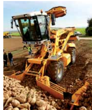
Okładka: Czyszczarko-ladowarka Kleine Cleanliner Mega Zdjęcie: Olszewski
