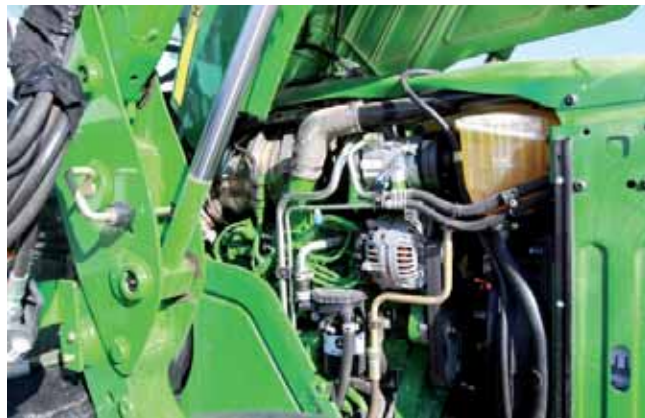
Silniki PowerTech PVX stosowane w serii 6M uzyskują maksymalny moment obrotowy przy 1500 obr./min silnika. W modelu 6125M wynosi on 564 Nm.
