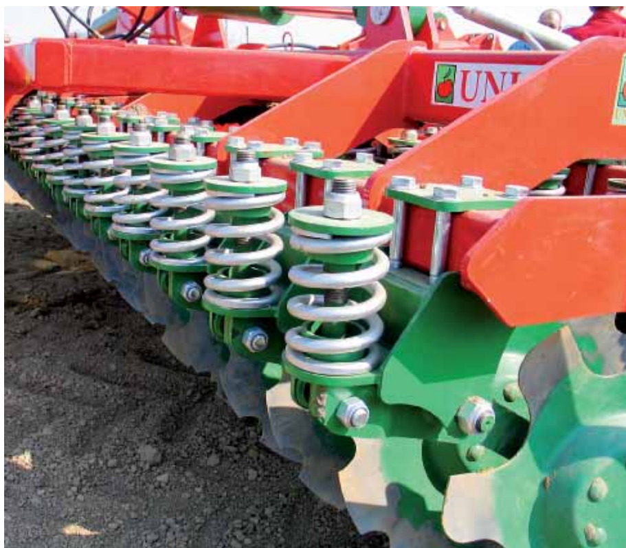
Połączenia gwintowe należą do najpopularniejszych elementów łączących części maszyn rolniczych.
